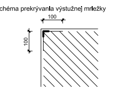
DETAIL 3 - Zateplenie ostienia okien
